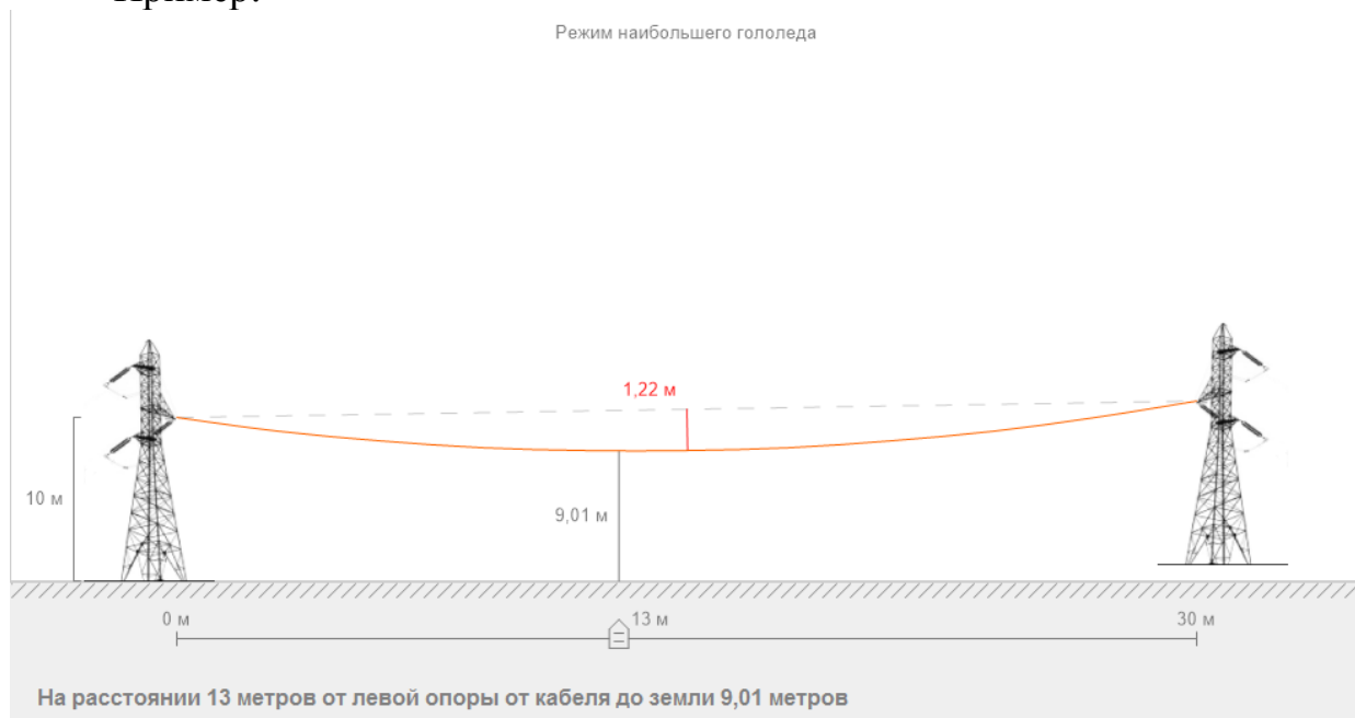
Рисунок 5 – Расчет допустимого провеса при монтаже на опорах ЛЭП
